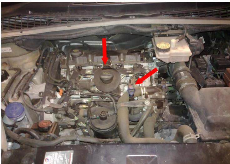
Ouvrez le bouchon de remplissage de l'huile moteur.
