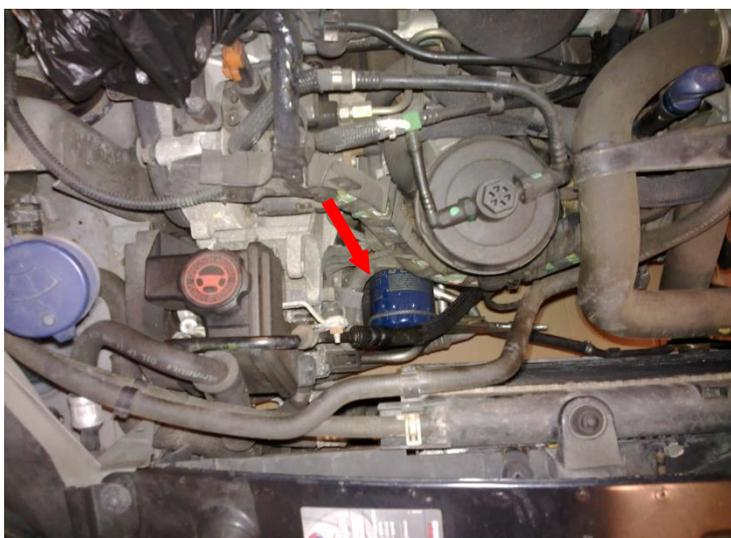
On positionne la clé à filtre autour du filtre et orientée vers le bas, puis on la serre bien fort, on fait aussi attention à ne pas endommager les ailettes du radiateur en aluminium par l'extrémité de la clé :
