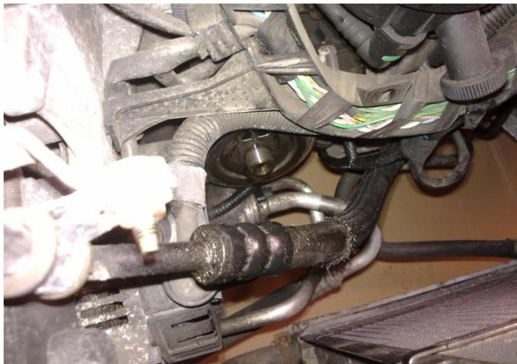
On nettoie à l'aide d'un chiffon non pelucheux le pas de joint afin de recevoir le nouveau filtre. On prépare ce dernier en huilant généreusement son joint de portée.
