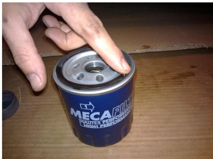
On repose le filtre en le serrant à la main uniquement. Vissez-le jusqu'au contact sur le socle. Dès le contact, continuez à visser de trois quarts de tours seulement.
