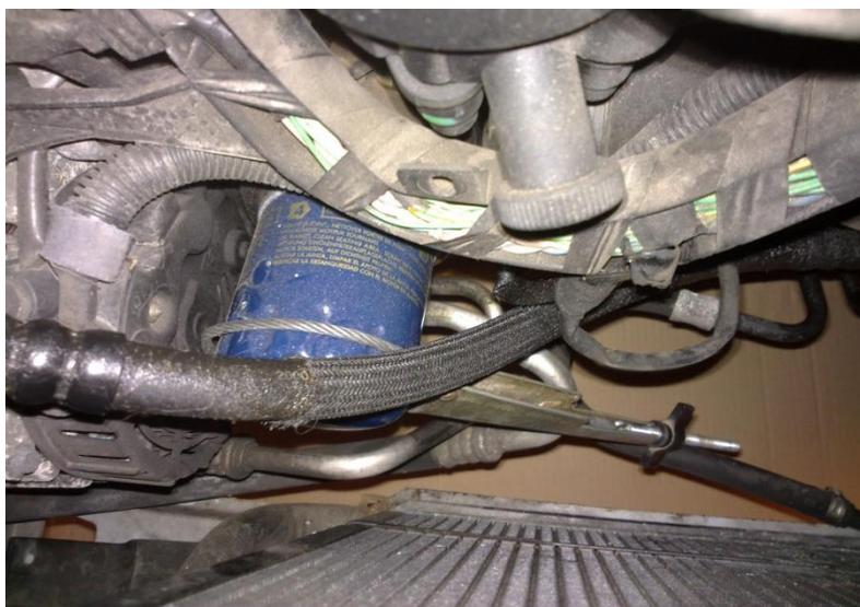
On dévisse dans le sens anti-horaire en desserrant, abaissant puis resserrant à chaque quart de tour la clé et ceci plusieurs fois jusqu'à ce que le filtre tourne sans résistance. Placer un nouveau carton au sol sous le filtre ainsi que plusieurs chiffons car, immanquablement, ça va couler un peu. Prévoir un emballage plastique étanche à proximité (sac plastique) pour emballer rapidement le filtre usagé. On obtient maintenant ceci :
