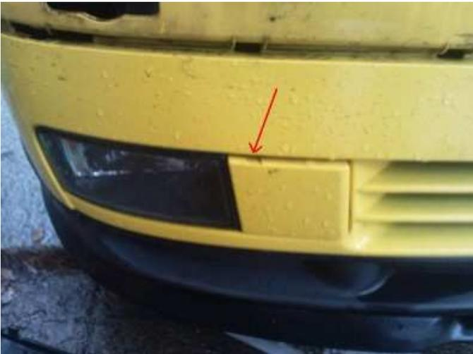
A l'aide du tournevis détache le cache à côté de l'anti-brouillard
