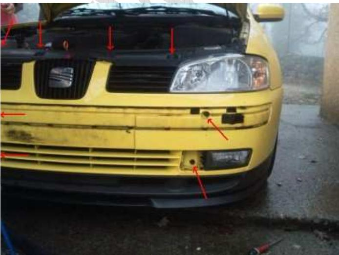
Dévisser les 4 vis du dessus, les 2 qui étaient derrière le bandeau et les 2 des antibrouillards, à l'aide de la plus grosse clé torx. Puis tirer car il y a encore des clips...
