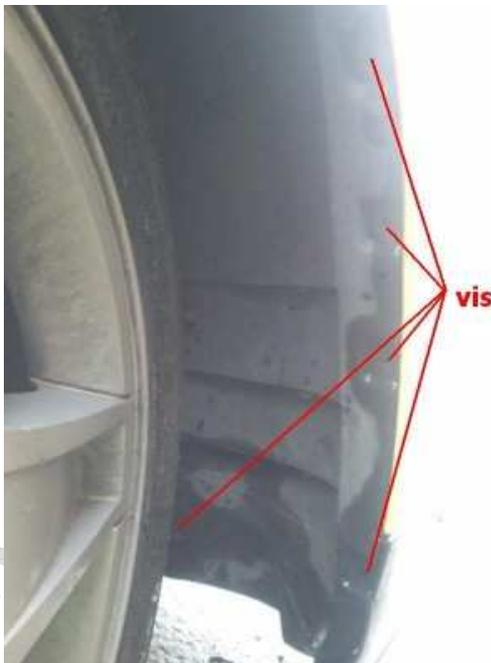
Démonter les vis du garde boue derrière le parechos des deux côtés avec la clé T25
