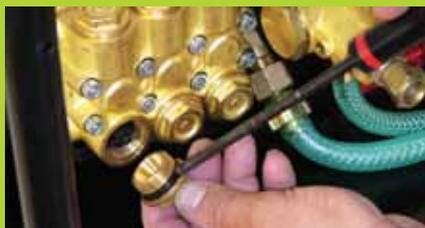
**Remplacement des joints et garnitures du bloc pompe** : ces pièces d'usures sont à remplacer périodiquement de manière préventive ou lorsque la pompe monte difficilement en pression.
