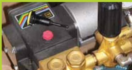
**Lors de la réception d'une pompe neuve**, veiller à bien remplacer le bouchon rouge de transport, du bloc pompe, par le bouchon jaune à soupape.
