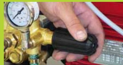
**Remplacement des joints et valve du régulateur** : ces pièces d'usures sont à remplacer périodiquement de manière préventive ou lorsque la pression de la pompe est irrégulière.
