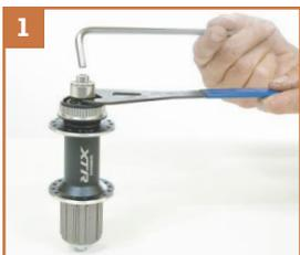
Les moyeux de cette série de photos sont des systèmes à billes. Avant de commencer le démontage, il faut déterminer avec quel outil on doit travailler. Toute composante mécanique comporte un indice visuel indiquant la forme de l'outil approprié.
