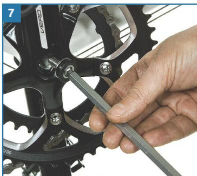
8. Pour vous assurer de l'installation adéquate de la manivelle, vérifiez le couple de serrage ou terminez avec la clé dynamométrique à la pression recommandée par le fabricant. **PHOTO 8**
