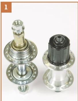
Le moyeu est la partie centrale de la roue. Il se fixe au cadre soit avec un axe et des écrous, soit à l'aide d'un système de déblocage rapide. En plus de stabiliser la roue au cadre, le moyeu fait tourner la jante. Celle-ci est fixée au flasque du moyeu avec les rayons. Le moyeu peut avoir un axe creux ou plein.
