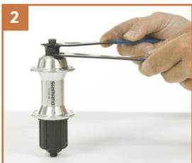
■ **PHOTO 1** Moyeu arrière Shimano XTR FH-M975 clé à cône de 17 mm sur le cône et clé hexagonale de 5 mm sur l'écrou de fixation
