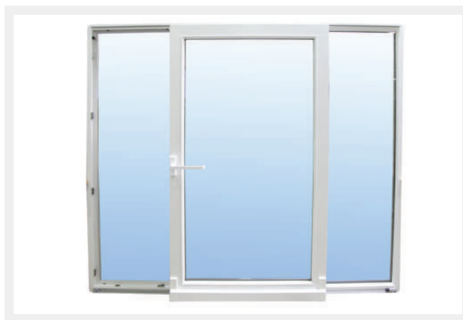
Châssis à déplacement latéral (translation). 1 vantail mobile, un vantail fixe. Le vantail mobile se plaque sur le dormant: optimisation thermique.
