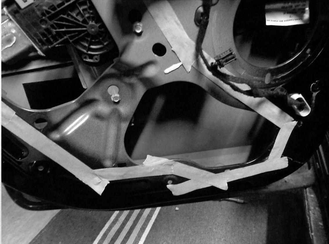
Le temps du montage, et pour ne pas détériorer le mastic auto-amalgamant, recouvrir celui-ci avec de l'adhésif de masquage à l'envers (pour que ça ne colle pas avec le mastic)
