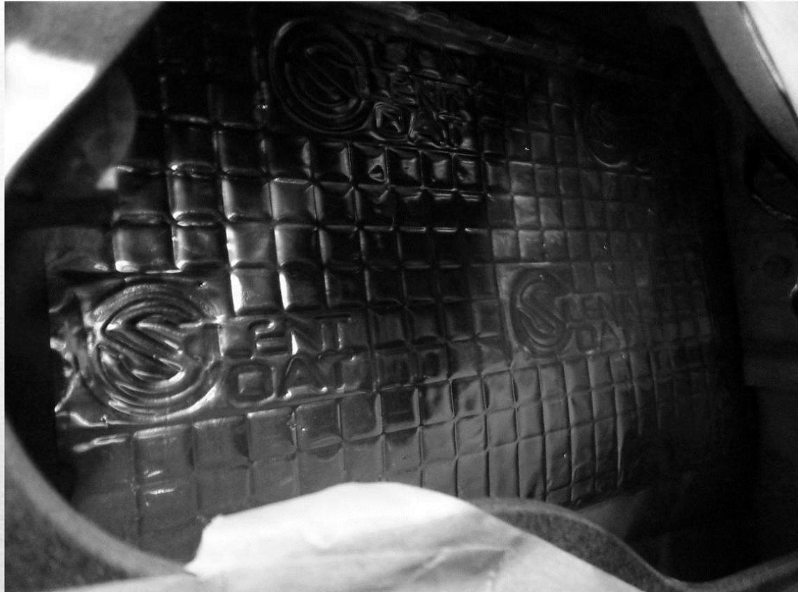
Dégrafer le faisceau électrique, puis habiller la porte avec les plaques anti-vibrations autocollantes. **4** ici ont été mises remplissant grandement l'intérieur de la porte (libre à chacun du nombres)
