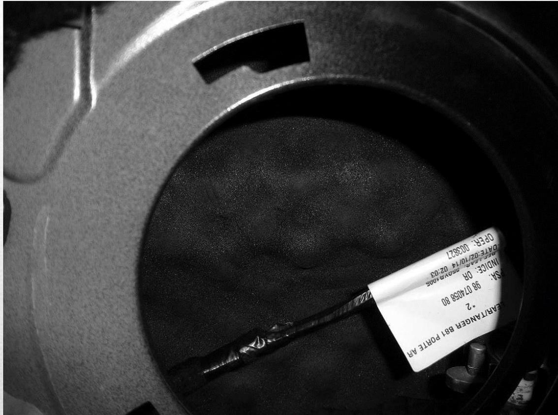
Puis, poser la mousse absorbante autocollante (ici 25\*25 cm) derrière l'emplacement du haut parleur (libre à chacun de la taille) et ré-agrafer le faisceau électrique
